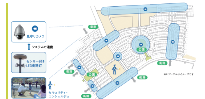
街全体に配置されたカメラ・照明・巡回による「街まるごとセキュリティ」の仕組み 出典：Fujisawa SSTコンソーシアム
