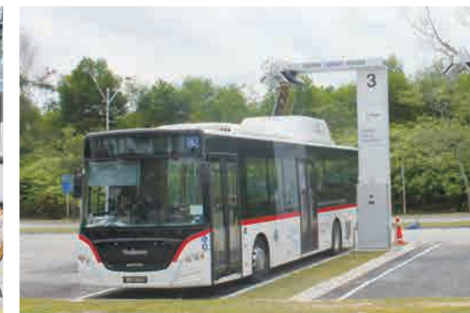
左:自転車シェアリングサービス。写真はシンガポール発のOBike。自転車で搭載されたQRコードをスマホで読み込めば、どこでも借りられてどこにでも返せる。 出典:URLinkage Co.,Ltd. 右:待機所に設置されているEVバスの充電パース。 出典:URLinkage Co.,Ltd.
