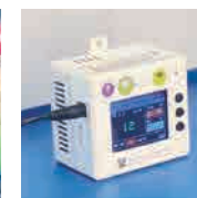
ダストボーイ (大気質モニター装置)
